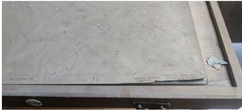
Slika 2. Katastarski plan izrađen na staklu – detaljan plan iz razmjere 1:500 prelazi na 1:1000
