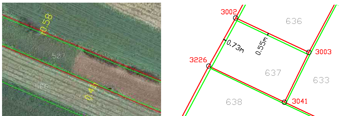
Slika 5. Primjeri razlika u položaju nakon usporedbe koordinata dobivenih računanjem iz tahimetrije i vektorizacijom – granica izračunata tahimetrijom (crveno), granica iz vektorizacije (zeleno).
