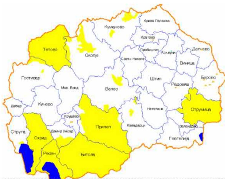
Slika 1. Katastarski premjer (na osnovi terenskih mjerenja - označeno žutom bojom) u Republici Sjevernoj Makedoniji, period 1928.–1945 (Fetai 2009).
