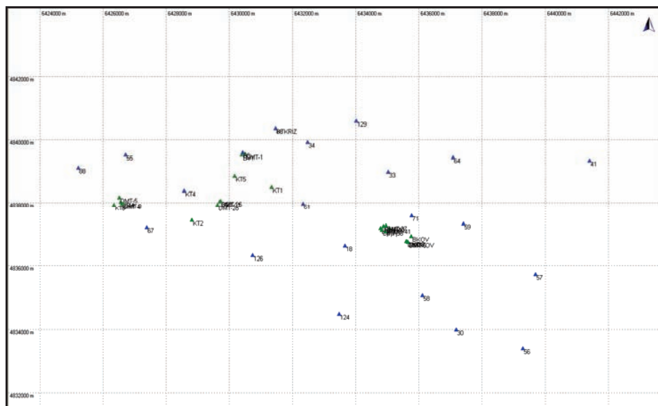
Slika 5. Postojeća (plava boja) i novouspostavljena (crna boja) geodetska osnova
