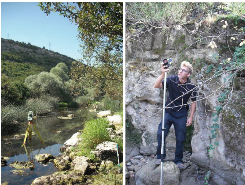
Slika 7. Poligonska mjerenja kroz riječno korito r. Šuice i snimanje ponora Kovači (Stephen Bechert)
