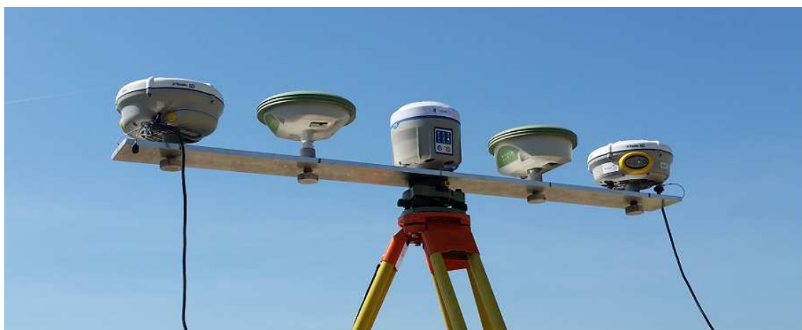
Slika 5. GNSS uređaji na aluminijskoj šipki tijekom opažanja (Milec 2015).
